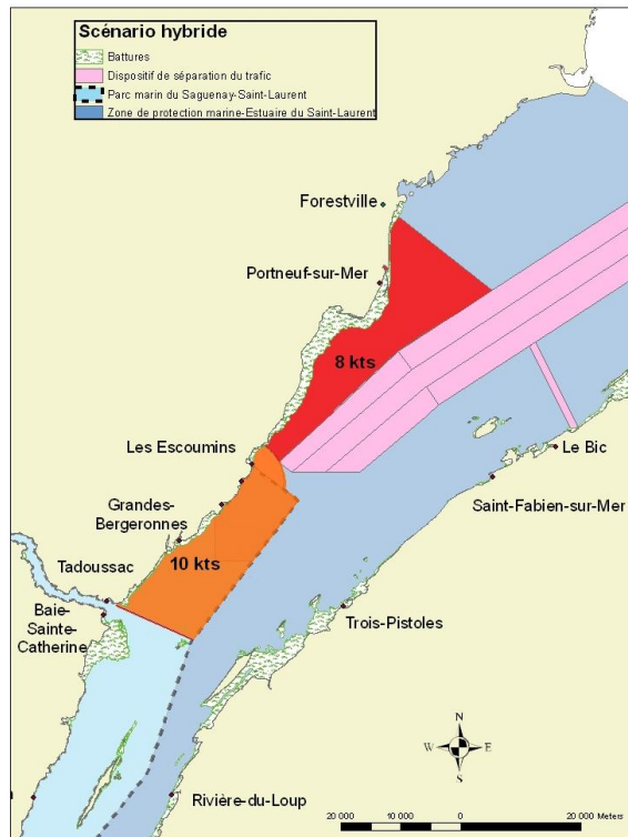
Carte 28 : Limites de vitesse pour les navires marchands recommandées au G2T3M. Le scénario hybride modifié retenu est composé d'une zone limitée à 10 nœuds dans la section estuaire maritime du parc marin et une zone de navigation côtière limitée à 8 nœuds en aval du parc marin.
